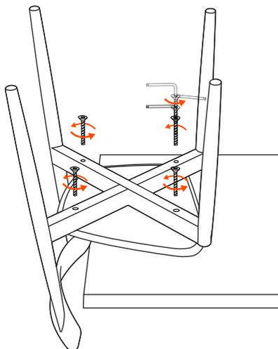
Posizionare la struttura della sedia capovolta sopra la seduta e avvitare i due componenti con le viti fornite. | Put the chair's structure over the seat, upside-down, and screw the two elements with the supplied screws.
